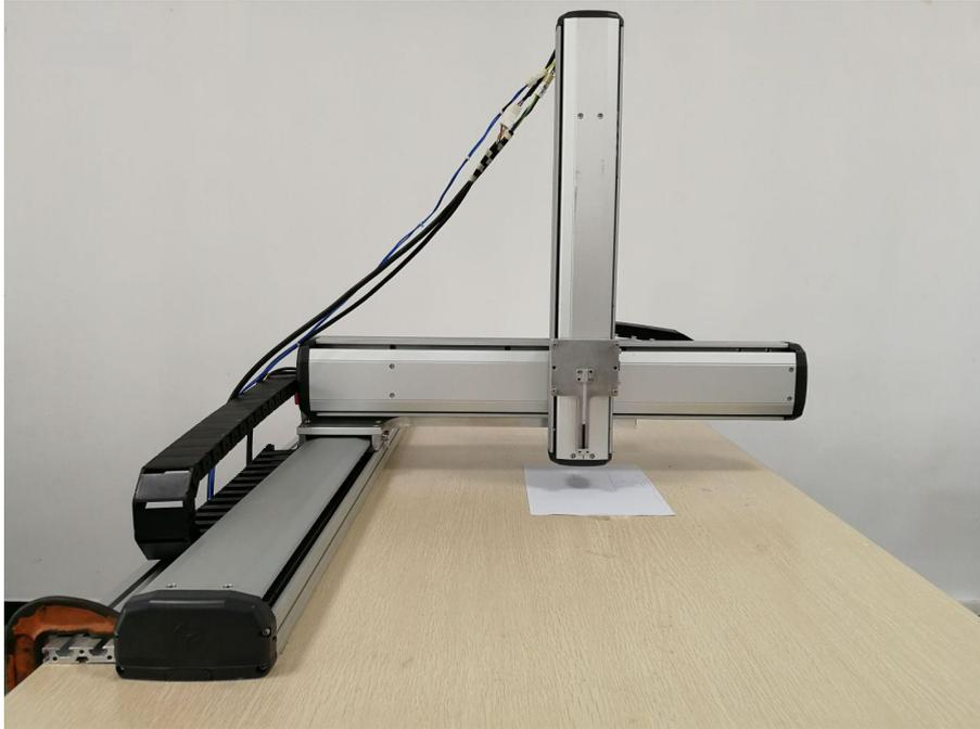
若铂三轴机器人是若铂自主设计的一款结构紧凑、密封性好、多功能的伺服专用横走式机器人，具有高速、高精度、高刚性的优势，产品采用了自主知识产权的交流伺服驱控一体机，实现了运动的精准性、灵活性和快速性，重复定位精度高，可实现多种场景的嵌入应用，在生产运用中灵活性强。
